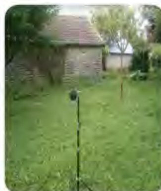
Exemple de sonomètre utilisé lors des mesures acoustiques
